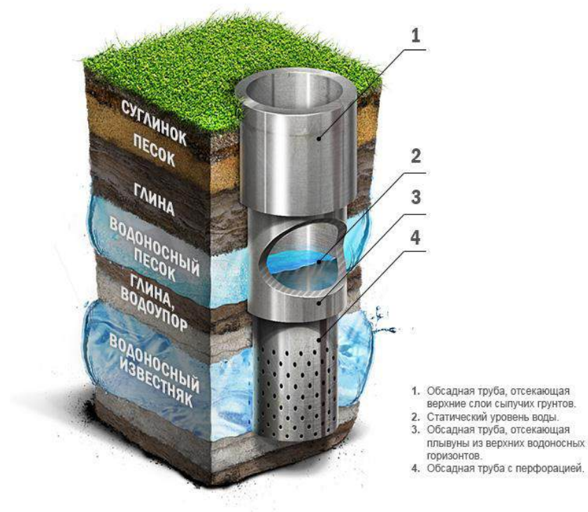
Рисунок 6. Схема артезианской скважины.
